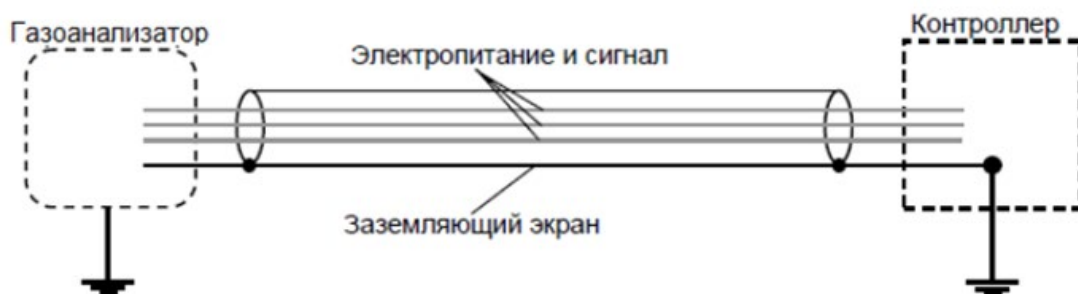
Рисунок 18 — Заземление экранированного кабеля
